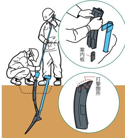
**7** 安定板体が半分以上地中に没したところで打込み筒を引抜きます。(引抜き板を逆叩きすると簡単に抜けます。)
