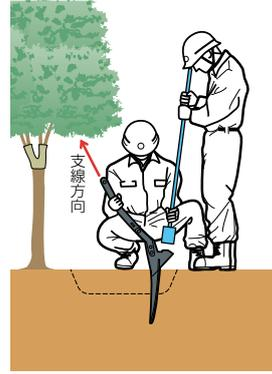
**3** 安定板受けの上端が穴底に達したところで打込み筒を当てがいます。
