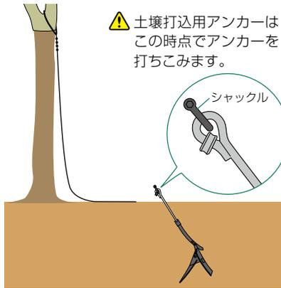
**3** シャックルにターンバックルを取付けます。
